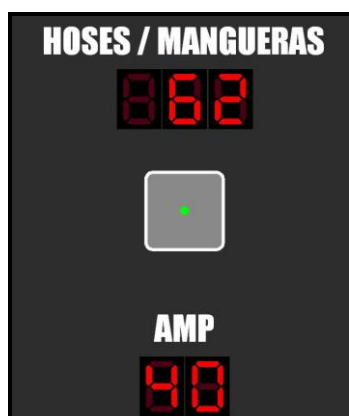
HOSE TEMP ON czujnik TCS w przewodzie ISO
